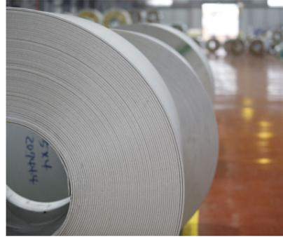
제강을 마친 슬라브(Slab)를 열간압연(1,150~1,300℃) 후 소둔, 산세를 한 제품으로 내식성을 요구하는 산업전반에서 가장 일반적으로 사용되는 소재입니다. 황금에스티는 정밀 제어 레벨러를 통해 높은 수준의 평탄도를 유지하며, Tension Control로 코일 형상 교정 및 길이 오차를 최소화하여 고객의 요구에 부응하는 다양한 열연제품 공급을 위해 최선을 다하고 있습니다.
