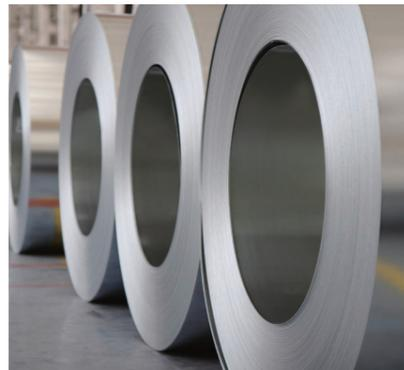
황금에스티는 2003년 HL 및 No.4 제품 개발을 필두로 2005년 No.8 제품까지 Coil to Coil 자체 생산라인을 보유하고 있습니다. Hair Line의 경우 국내 최초 5ft HL 설비 도입을 시작으로 현재 Rotary Shear 전단방식으로 연간 3만톤 규모의 냉연을 생산하고 있습니다. 냉연제품은 엘리베이터, 건축 내외장재, 주방용품 등 다양한 산업분야에 사용되고 있습니다.
