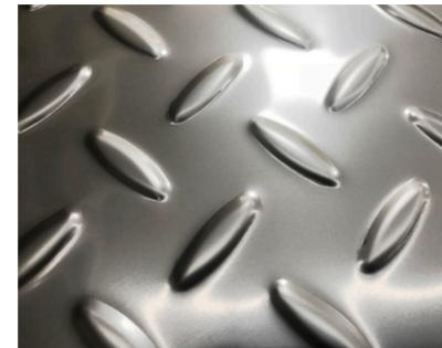
표면에 미끄럼 방지를 위한 요철이 있는 철판으로 플랜트 및 선박의 바닥재, 계단의 디딤판에 주로 사용되며 Standard type과 Non-slip 기능을 강화시킨 Bold type이 있습니다. 당사의 체크판은 Roll Forming 과 Press Forming 방식으로 생산됩니다. Roll Forming 방식은 4T 이하의 제품 생산 시 사용되어 평탄도가 우수한 이점이 있으며, Press Forming 방식도 병행하여 사용 목적에 맞게 공급하고 있습니다.
